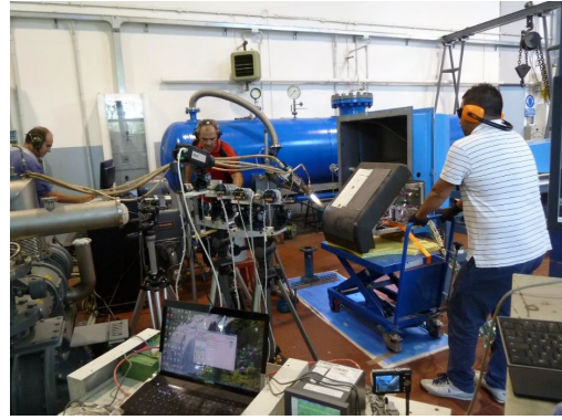
Test del sistema di protezione termica del veicolo ipersonico di rientro ESA - IXV
