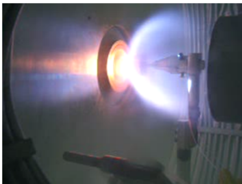
Tipici esperimenti nella galleria ipersonica ad arco
